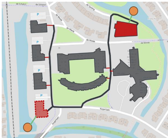
Figuur 19: Schematische voorstelling warmtenet cluster Hoep-noord
